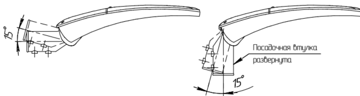
Рисунок 1.3 – Углы наклона светильника
